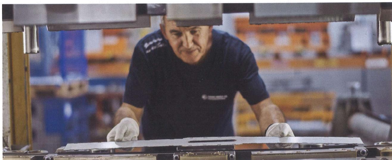
Der Blechrohling der Duschrinne wird in das Umformwerkzeug eingelegt. (Bilder: Eberle)
