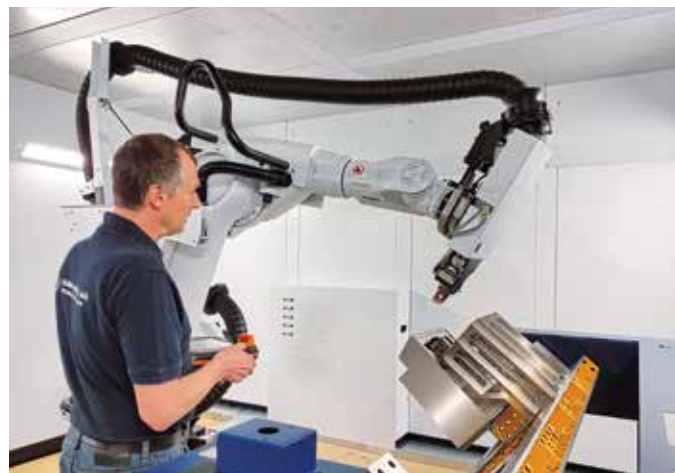
Qualität inbegriffen: Dank der ausgeklügelten Vorrichtungen des internen Werkzeugbaus können selbst dünne Bleche innert kürzester Zeit zum verzugsfreien Laserschweissen in Serien stabil und sicher aufgespannt werden.
