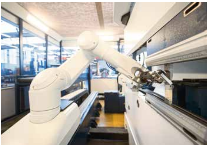
Kleine Bleche in grossen Serien biegen: Die mit zwei Robotern automatisierte Biegezone arbeitet äusserst zuverlässig und wiederholgenau.
