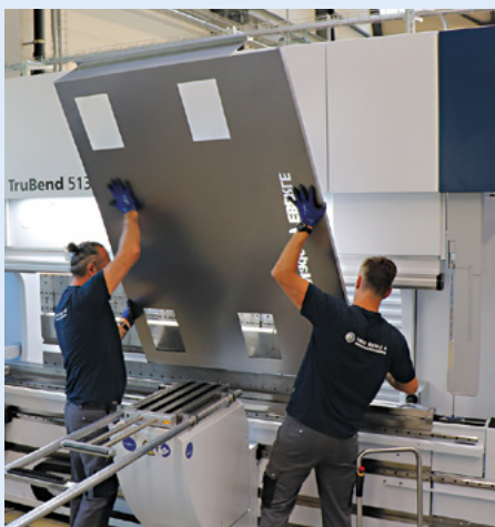
Zwei-Mann-Fertigung; Bearbeitung von grossformatigen Blechteilen. Eine zeitaufwändige und körperlich Anspruchsvolle Arbeit.
