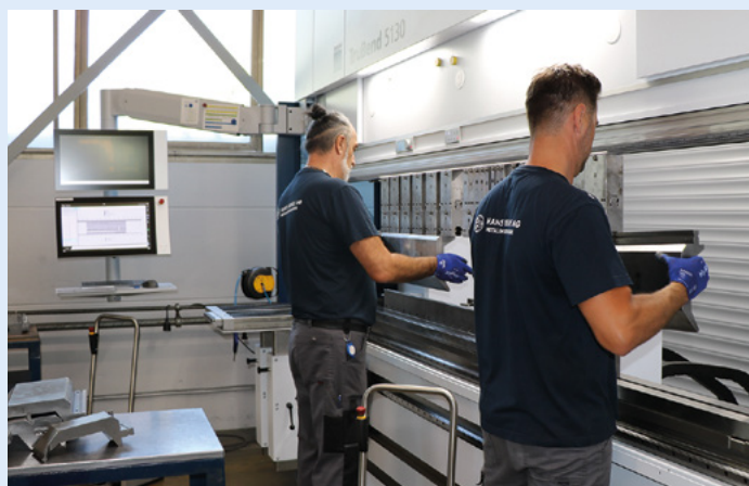
Das Rüsten des Abkantcenters mit Biegewerkzeuge.
