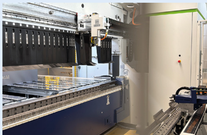
Das EVO-CENTER rüstet sich auf Knopfdruck vollautomatisch für den jeweiligen Biegeprozess ein.
