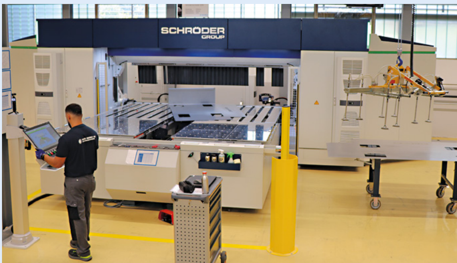
Neue Maschine, gleiches Blechstück; Der Vakuum-Drehteller übernimmt das Teilehandling, dadurch entfällt das manuelle Handling während des gesamten Biegeprozesses.
