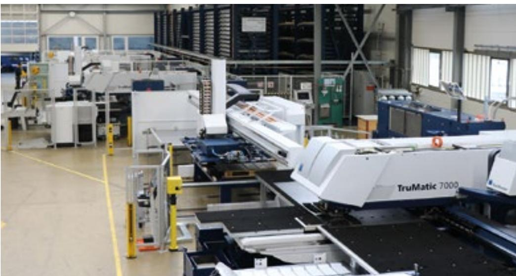
Modernste Stanz- und Lasermaschinen sorgen für eine präzise und effiziente Blechbearbeitung.
