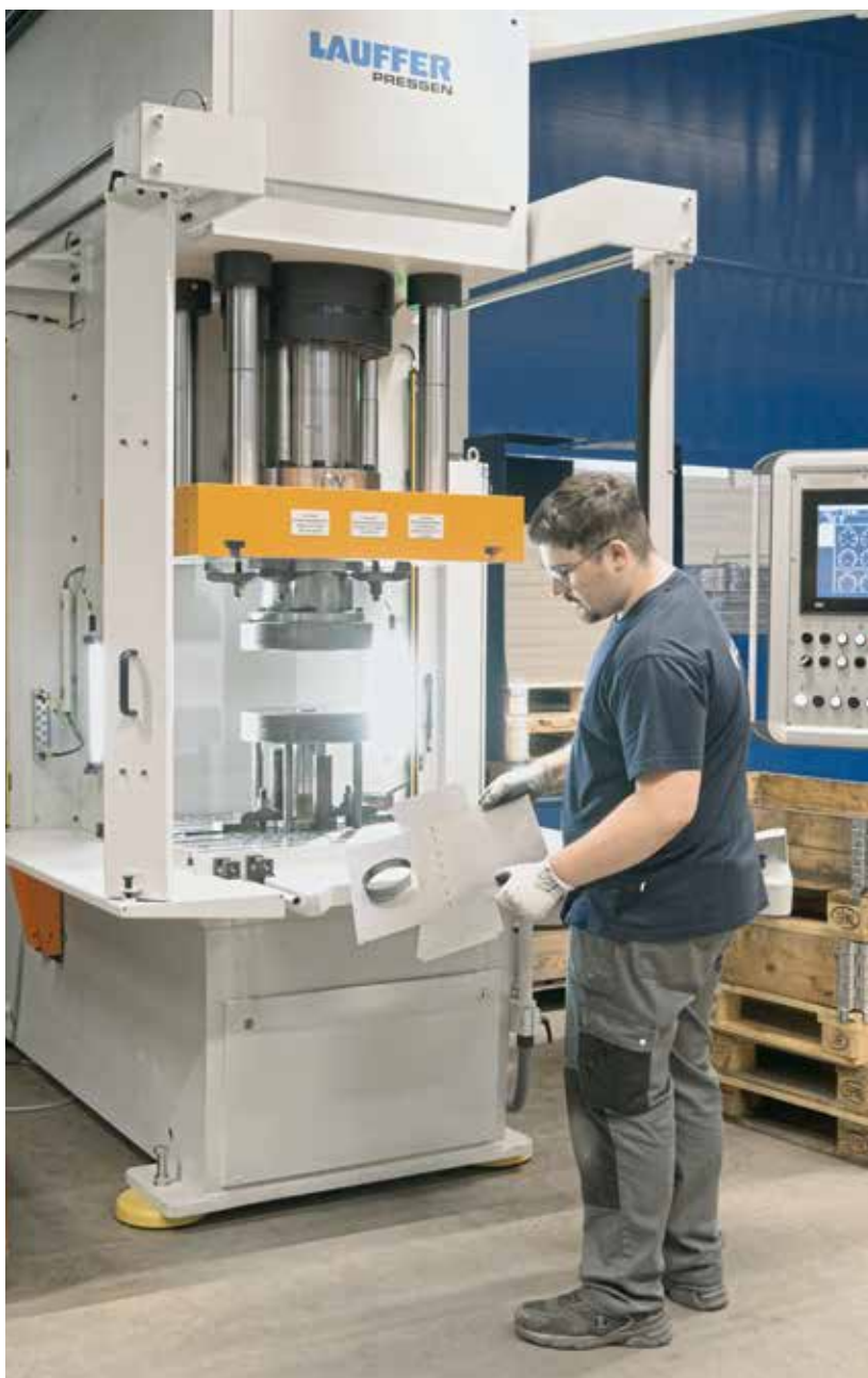
Mit der Investition in eine hydraulische, mit Ziehkissen ausgestattete Umformpresse stärkt die Hans Eberle AG ihre Ausrichtung als Komplettanbieter für Blechteile und Baugruppen aus Blech.
