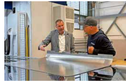
Die neue Maschine kann nicht nur eckig biegen, sondern auch rund: Hier zeigt sich das an einem Teil einer Abdeckung für eine Medizinalmaschine. Bild: Marco Lüthi
