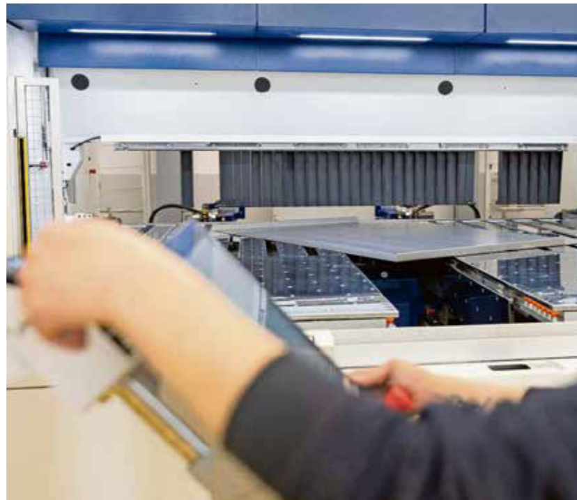
Die Schwenkbiegemaschine arbeitet beinahe vollautomatisch: Gesteuert wird sie von einem Mitarbeitenden über einen Touchscreen.
