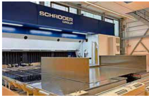
Innert weniger Minuten wird aus dem flachen Blech ein dreidimensionales Bauteil: Hier ist es eine fast fertige Ölaufangwanne für einen Trafo ... Bild: Marco Lüthi
